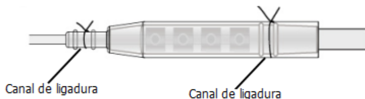
Figura 24. Atado de ligaduras alrededor de los canales de ligadura en ambos extremos de la funda.
