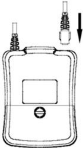
Figura 5. Inserte el enchufe del cable apantallado en la toma de la EPG.
