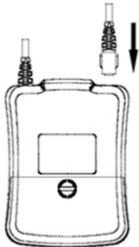
Figura 5. Inserte el enchufe del cable apantallado en la toma de la EPG.
