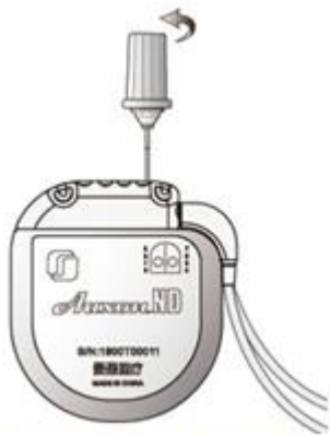
Figura 26. Ajuste de los tornillos de fijación en el sello de agua
