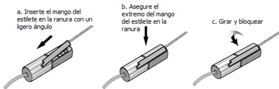
Figura 4: conexión del cable al cable Sure-Lock screening
