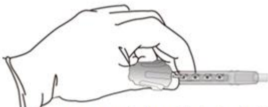
Figura 19. Apriete de los tornillos de fijación del conector de extensión percutánea
