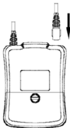
IMAGEN 2: Presione el conector del electrodo de conexión hacia el compartimiento del EPG.
