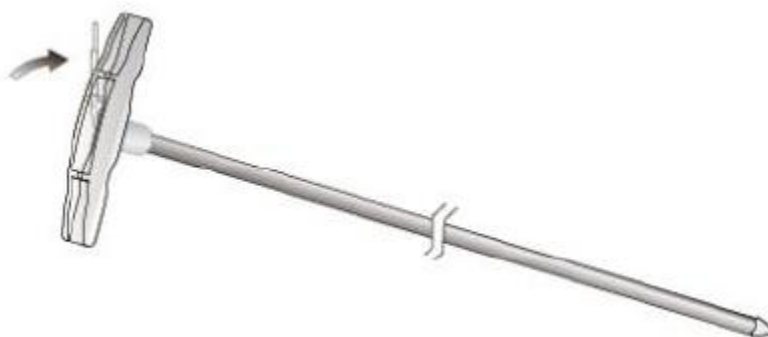
FIGURA 3: Encaje el obturador en el mango.
