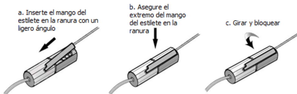
Figura 4: conexión del cable al cable Sure-Lock screening
