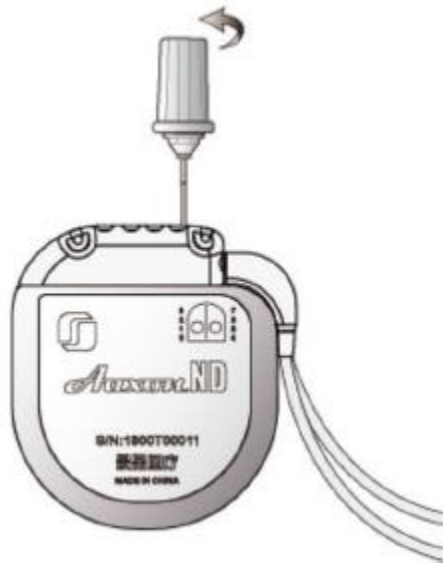
IMAGEN 2: Apriete los tornillos de fijación en el sello a prueba de agua
