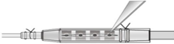
Figura 20. Corte de la ligadura y la funda del conector para exponer los tornillos de fijación
