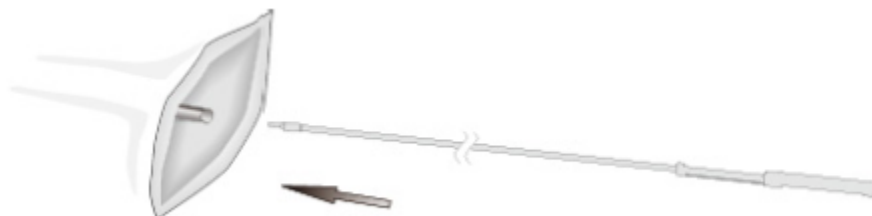
FIGURA 5: Deslice el portador en el pasador de extensión.
