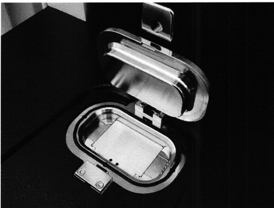
Figura 3-4 El puerto de carga que contiene una placa de muestras MALDI microScout
