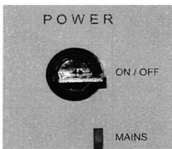
Figura 3-2 Interruptor de corriente en la posición ON (ENCENDIDO), horizontal
