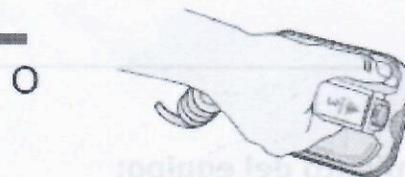
Si se pulsan los botones DESCARGA en las palas cuando la unidad se está cargando, aparecerá un mensaje *Liberar botón descarga* en la pantalla.
