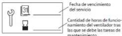
Las horas de mantenimiento del ventilador de la unidad se indican en el software de la unidad, en el menú Información.
