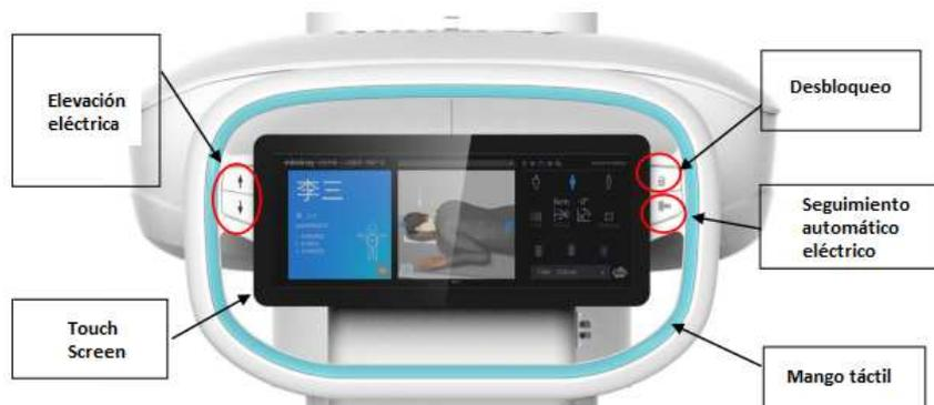
La función "Desbloqueo" indica que al presionar y mantener presionado, el conjunto de tubo-colimador se puede mover hacia arriba y hacia abajo verticalmente, en el sentido de las agujas del reloj, en el sentido contrario a las agujas del reloj y horizontalmente.
