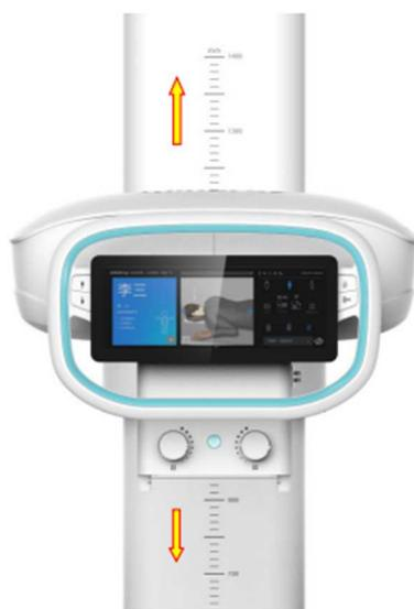
Sostenga la manija táctil de 360° para desbloquear. Presione levantar/bajar y el Conjunto se puede mover hacia arriba y hacia abajo verticalmente a lo largo del soporte del tubo. Suelte el botón y se detendrá el movimiento; suelte el mango y el movimiento se bloqueará.
