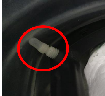
Figura 1-22: Tapones protectores de silicona de la membrana en la extremidad del tornillo
