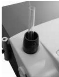
B) Para la pieza de mano de focal fija, inserte la pieza de mano en el adaptador como se indica en la figura 19. La pieza de mano debe estar completamente vertical. Para la pieza de mano de focal variable, coloque la pieza de mano con su punta espaciadora sin adaptador como se muestra en la figura siempre en posición completamente vertical.
