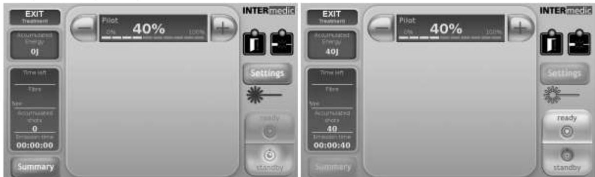
En esta pantalla se puede cambiar la intensidad con los botones (+) y (-). Los valores de intensidad se pueden ajustar de 0% a 100% en pasos de 10%.
