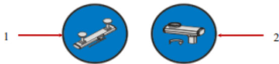
Diagrama de botones de control de rotación y deslizamiento del colgante de techo tipo puente
