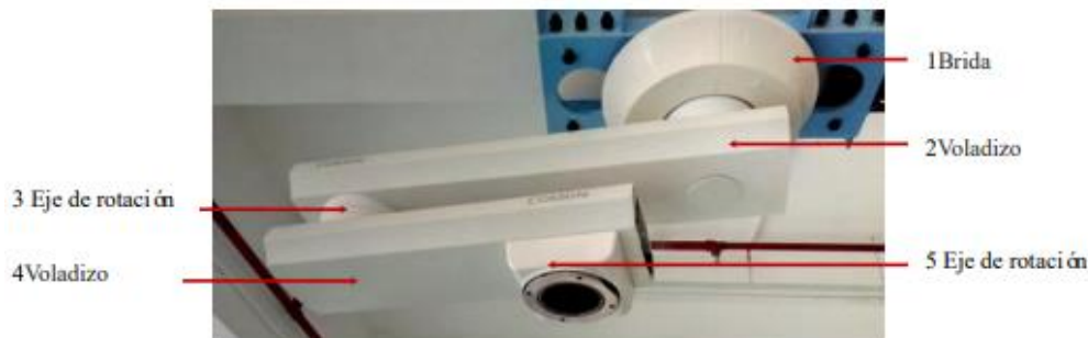
Diagrama esquemático de la instalación del voladizo
