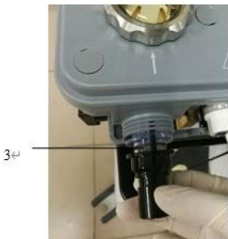
4. Alinee la articulación respiratoria y la tuerca de bloqueo con la interfaz del sensor de caudal y apriete la tuerca de bloqueo en el sentido de las agujas del reloj.
