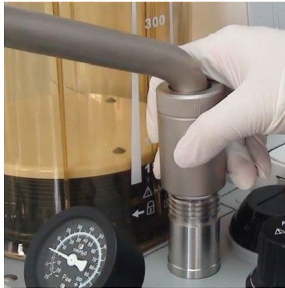
3 Apriete la tuerca roscada en el sentido de las agujas del reloj, como se muestra en la figura de la derecha:
