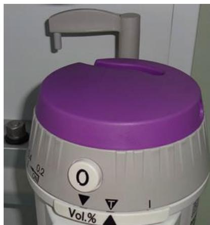
3. Asegúrese de que la parte superior del vaporizador de anestesia esté horizontal. Si no es así, retire el vaporizador y vuelva a instalarlo.
