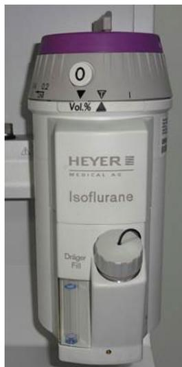
2. Gire la barra de bloqueo en el sentido de las agujas del reloj para fijar el vaporizador de anestesia en la base del vaporizador, como se muestra en la siguiente figura:
