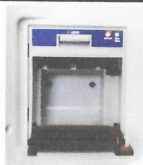
Figura Apertura de la tapa del registrador.
