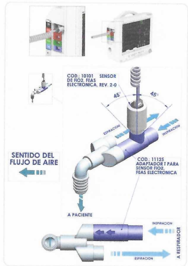
Figura - Conexionado de FiO 2 , ensamblado de componentes Figura - Conexionado de FiO 2 , posición final de la celda de O 2
