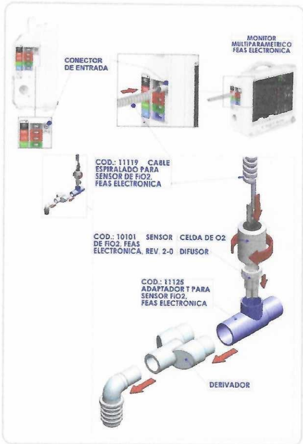
Figura - Conexionado de FiO 2 , ensamblado de componentes Figura - Conexionado de FiO 2 , posición final de la celda de O 2
