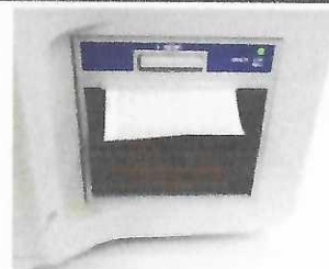
Figura Cierre de la tapa del registrador.
