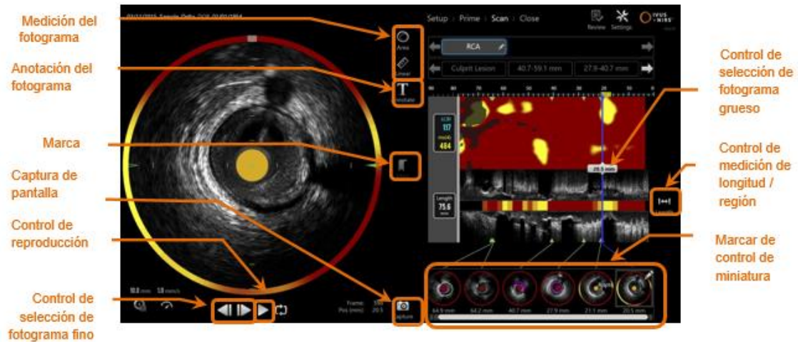
Figura: Fase de escaneo del modo de adquisición con los controles básicos indicados
