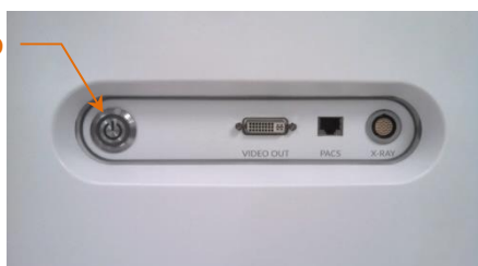
Figura: Panel lateral del Sistema de Imagen Intravascular Makoto™ con el botón de encendido resaltado.
