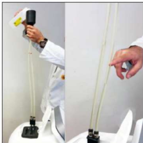
Figura 4.5: Llenado del Sistema de refrigeración
