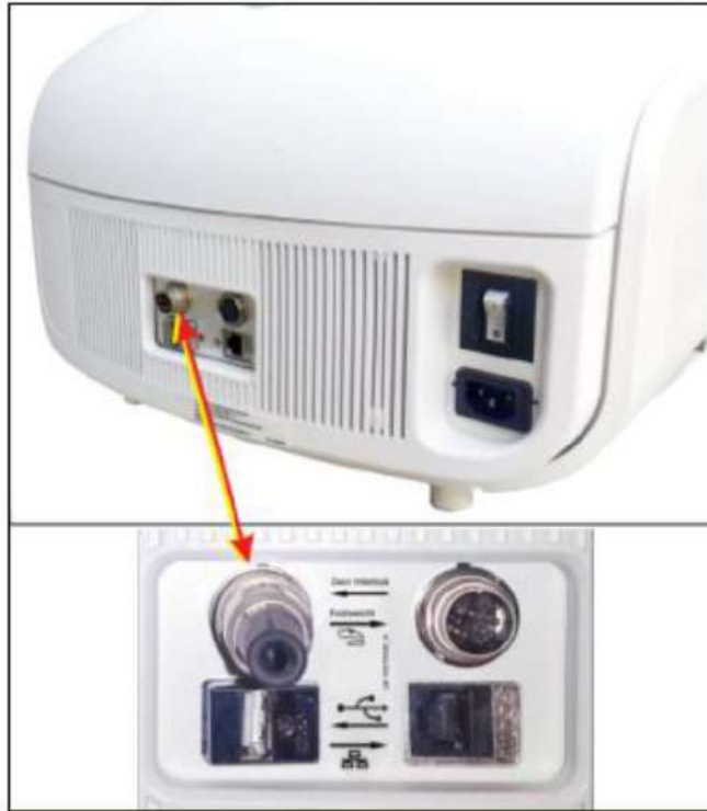
Figura 4.8: Enclavamiento de puerta externa
