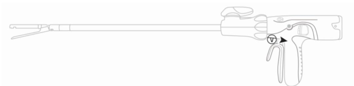
**Ilustración 09 – Eliminar Battery Pack**
