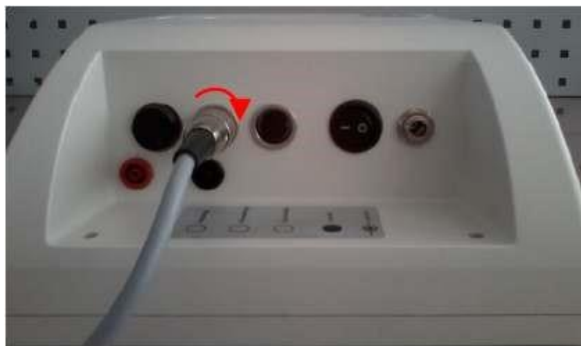
Figura 7: Colocación de los conectores
