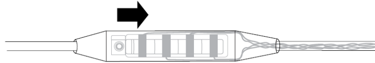
Figura 26. Introduzca totalmente el electrodo en el extremo del conector del electrodo de la extensión percutánea
