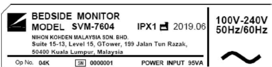
Figura 2.d: Rótulo colocado sobre el equipo, modelo SVM-7604.
