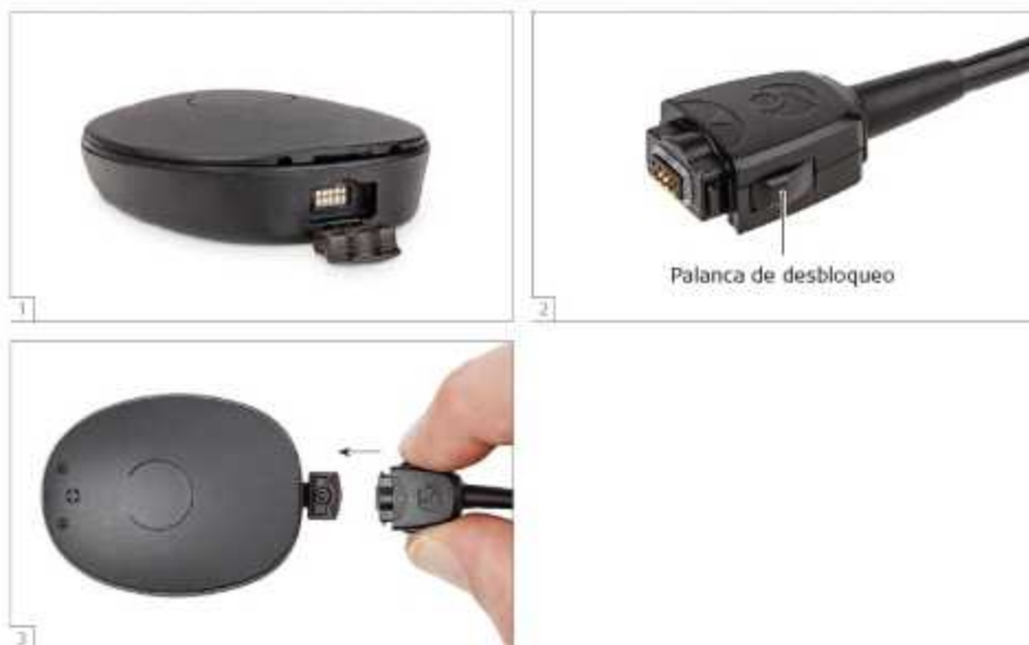
Fig. 18 Conexión del cable de programación a un procesador de audio RONDO
