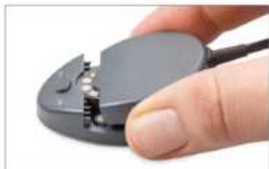
Fig. 17 Conexión del cable de programación a un procesador de audio RONDO
