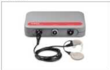
Fig. 14 Conexión de un procesador BTE a la MAX Programming Interface
