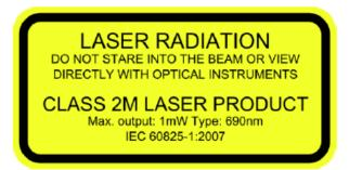
Estas advertencias de láser se colocan el dispositivo de escaneo láser, cerca de la abertura con información sobre la clasificación del láser. El láser está clasificado como de Clase 2M, según la norma IEC 60825-1, y cumple con los estándares de rendimiento de la FDA para productos láser, con excepción de las desviaciones de conformidad con el aviso Laser Notice NO. 50, con fecha de 24 de junio de 2007.
