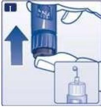
Δ Siempre asegúrese de que una gota de insulina aparezca en la punta de la aguja antes de inyectarse. Esto asegura que la insulina fluye. Si no aparece una gota, no se inyectará insulina aunque el selector de dosis se mueva. Esto puede indicar una aguja bloqueada o dañada.
