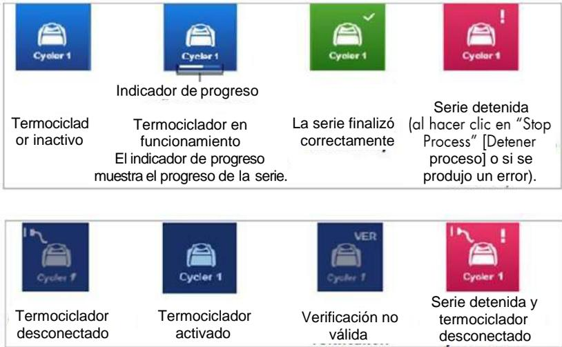
Figura 13. Los íconos de termociclador Rotor-Gene Q MDx 5plex HRM que pueden aparecer.
