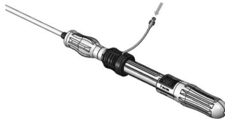
Imagen 14: Conecte la línea de presión.
