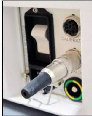
Figura 4.7: Conexión de enchufe de interbloqueo remoto
