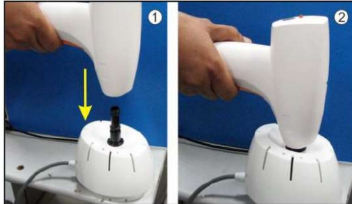
Figura 4.11: Colocación de la pieza de mano Multi-Spot Nd: YAG en el dispositivo de calibración
