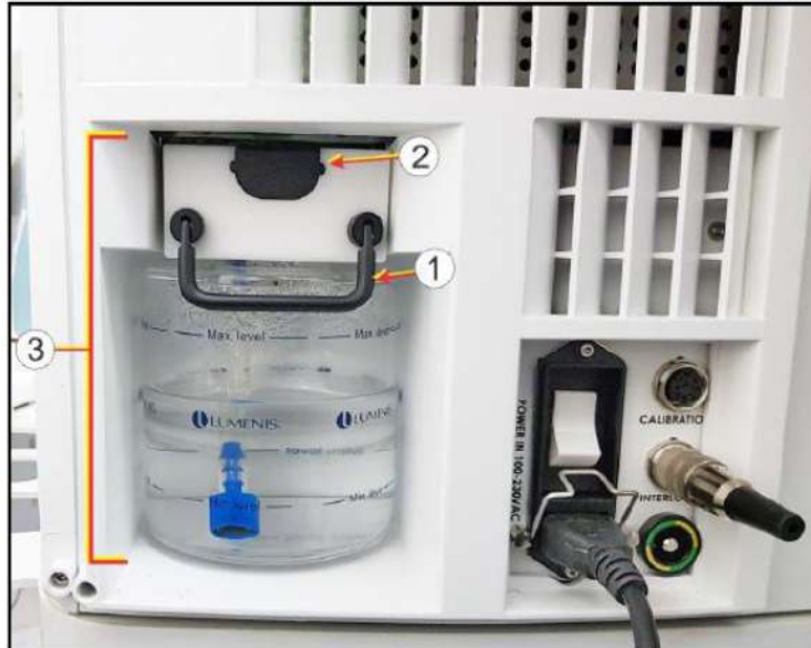
Figura 4.10: Llenado de depósito de Refrigerante
