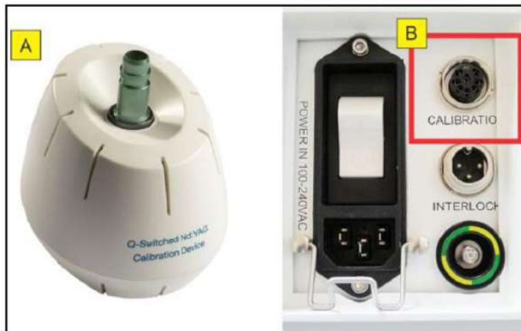
Figura 4.12: Conexión el dispositivo de calibración Q-Switched Nd: YAG al puerto del panel de servicio
