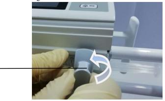
5. Mientras presione el mango de descarga, empuje la varilla hacia la izquierda hasta el extremo del pistón de la jeringa, como muestra la figura:
