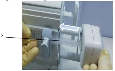
6. Afloje el mango de descarga presionado, se cerrará la traba de la varilla y se fijará el extremo del pistón de la jeringa, como muestra la figura:
