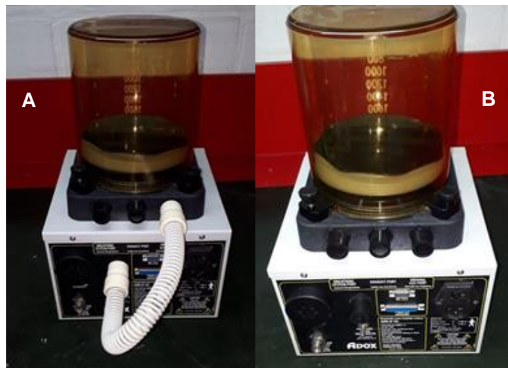
Figura 2: A) Ventilador para anestesia con tubuladura que conecta la salida del gas impulsor a la entrada gas impulsor del fuelle. B) Ventilador para anestesia sin tubuladura.
